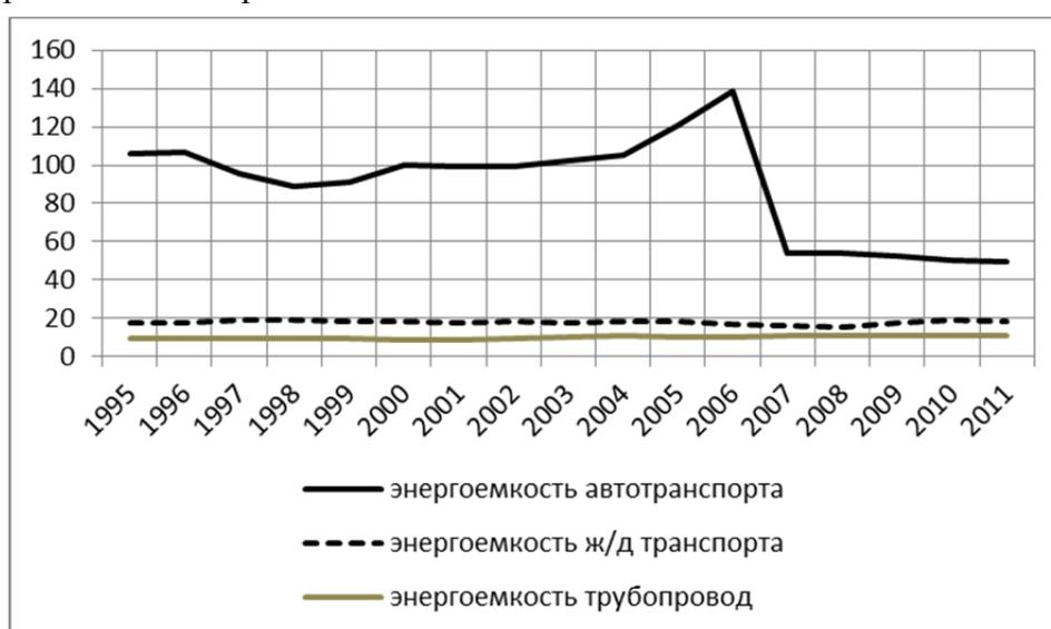
**Рис. 1. Энергоемкость различных секторов транспортной отрасли**
